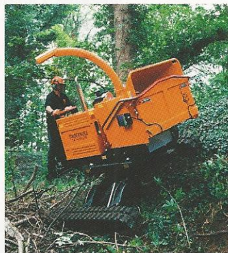
TW 190 TVGTR (chenilles à largeur variable et correction de dévers)
